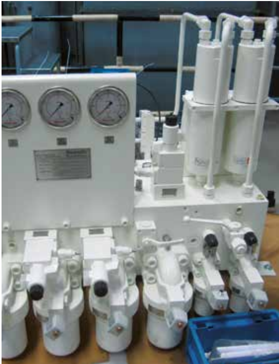
Schiffshydraulik im Offshore-Bereich (rechts oben zwei Druckverstärker HC6D)
